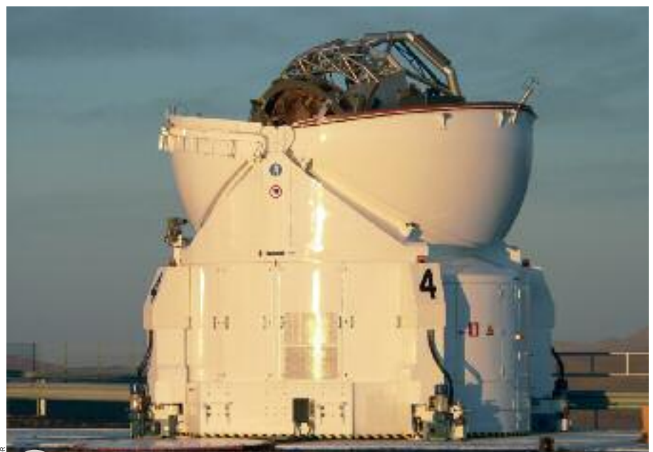
Conception, fabrication et assemblage des télescopes auxiliaires mobiles (ATS) par AMOS, à l'instar du Very Large Telescope Interferometer (VLT) à Cerro Paranal (Chili)
