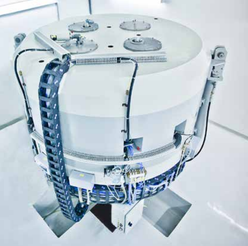
Le Cyclotron Cyclone 18 d'IBA est un accélérateur de particules qui permet la production d'isotopes radioactifs
