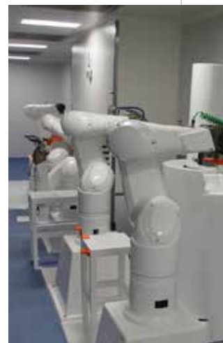
La ligne entièrement robotisée de production de greffons osseux mise au point par TEXERE Biotech
