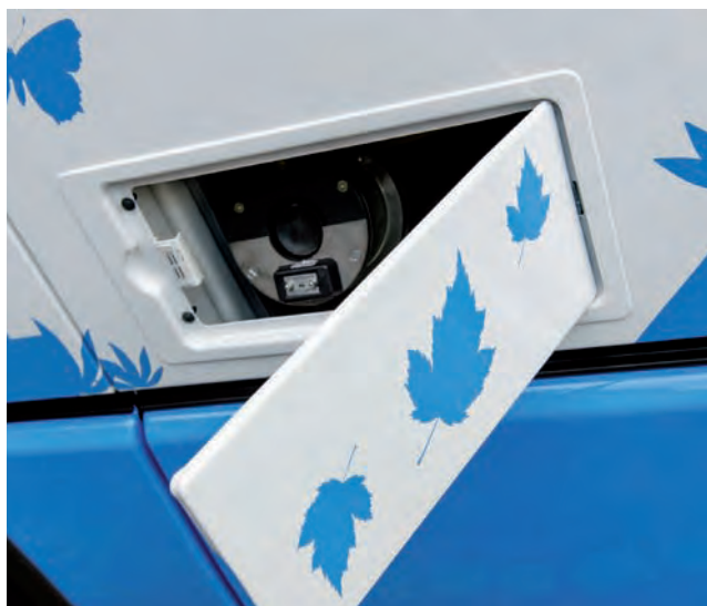
Prise de recharge des batteries
